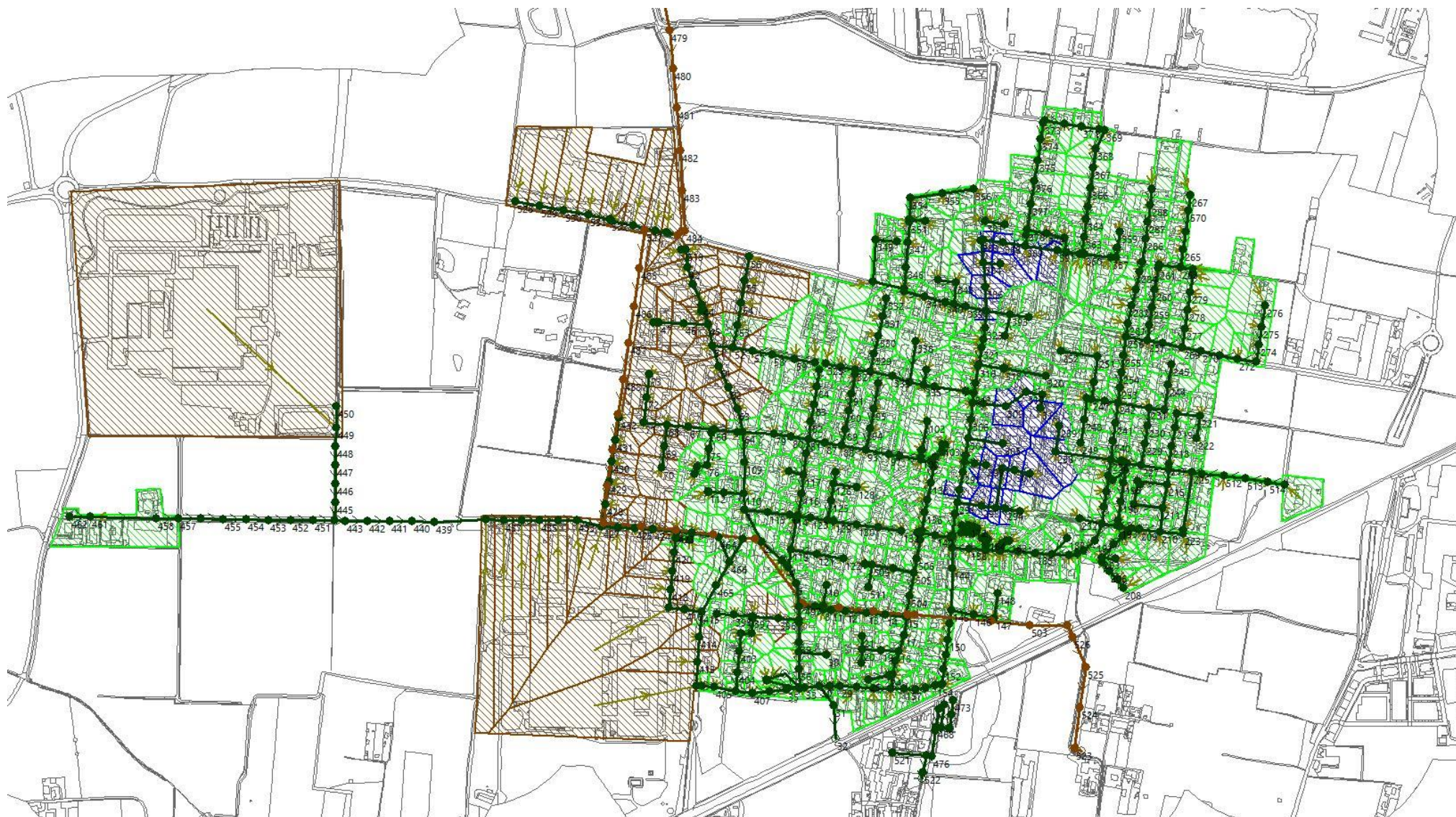
Figura 10 - Scomposizione bacino scolante in sottobacini - Verde: residenziale, Blu: centro storico, Bruno: industriale
